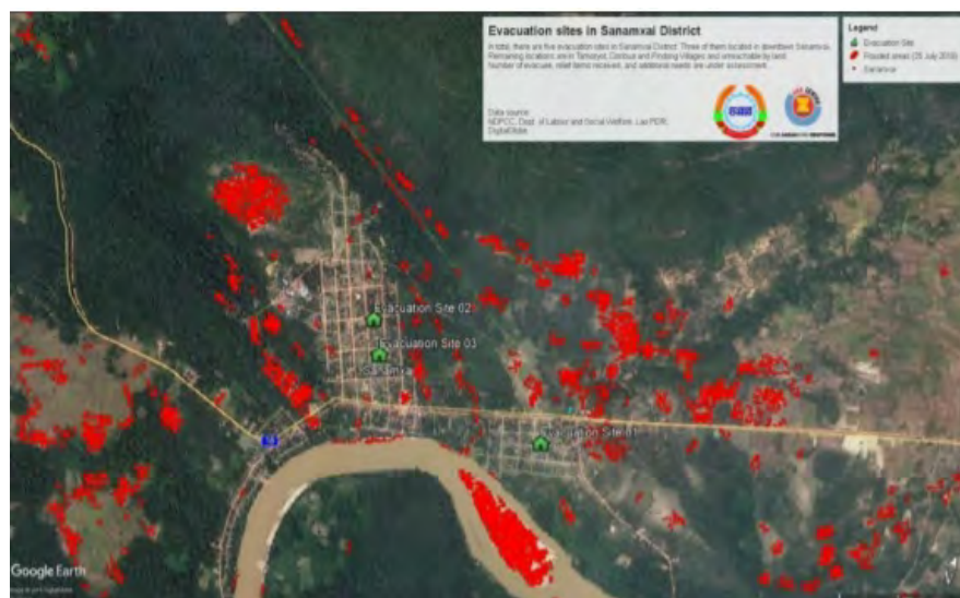
2018年7月にラオスで発生した洪水被害にて「だいち2号」の観測データより推定された浸水被害地図
