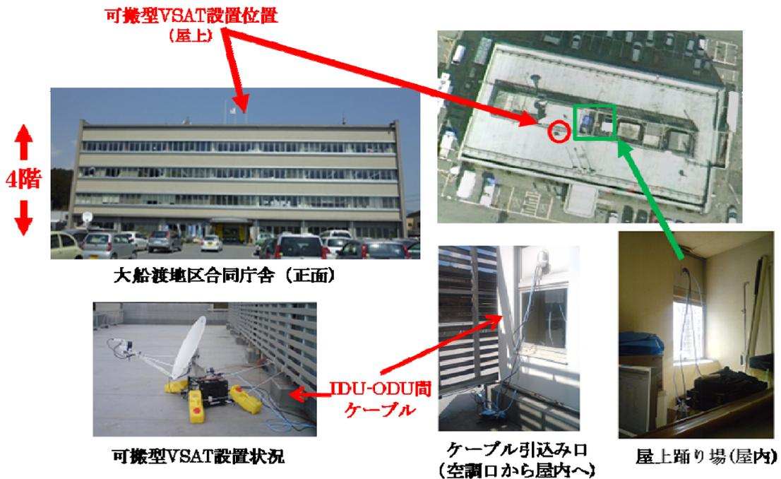
図 2.2-8 大船渡沿岸広域振興局への屋外装置 (ODU) 設置状況
