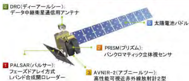
人工衛星 だいち(ALOS)の形状や搭載パーツについて
