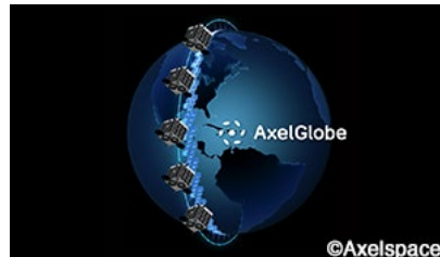
日: Axelspace Axelglobe(2021~) 光学100kg, 1機→10機 2.5m分解能, 57km幅 頻度1回/1日
