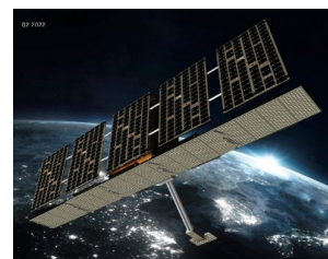
ICEYE (C)ICEYE フィンランド, 2018年~ XバンドSAR, 約120 kg 21機 (2022年8月時点)
